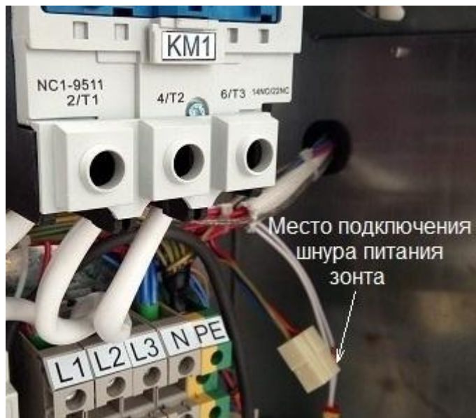
Рис.1 Подключение шнура питания зонта к колодке 45.7373.9005 пароконвектомата
